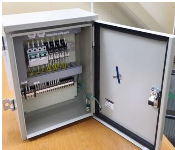
配電ボックス
